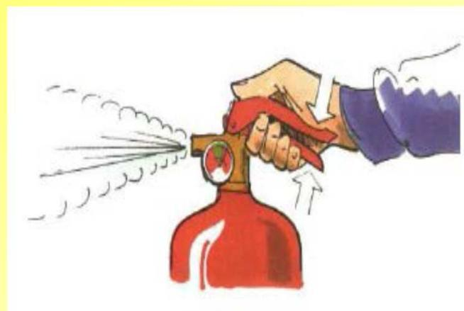
Azionare l'estintore alla **giusta distanza dalla fiamma** per colpire il focolare con la massima efficacia del getto, compatibilmente con l'intensità del calore della fiamma.
