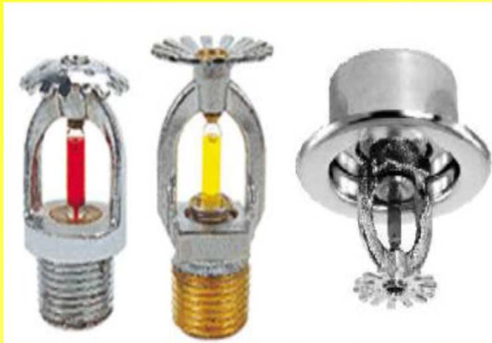
*L'erogazione di acqua può essere comandata da un impianto di rilevazione incendi, oppure essere provocata direttamente dalla apertura delle teste erogatrici: per fusione di un elemento metallico o per rottura, a determinate temperature, di un elemento termosensibile a bulbo che consente in tal modo la fuoriuscita d'acqua.*
