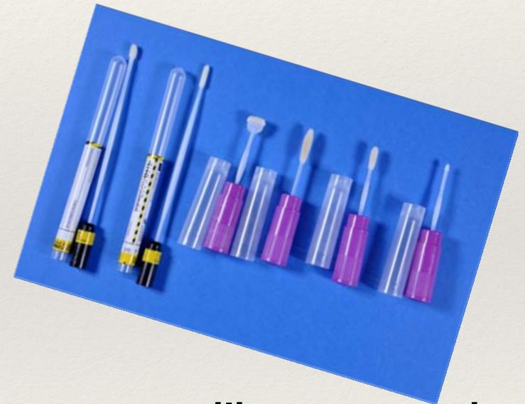
I tamponi utilizzati vanno custoditi all'interno di provette sterili e conservati in ambiente refrigerato controllato a -20°C
